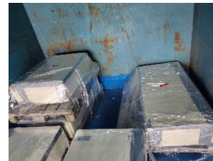
Abb.3 fachgerecht verpackte Nachtspeichergeräte
